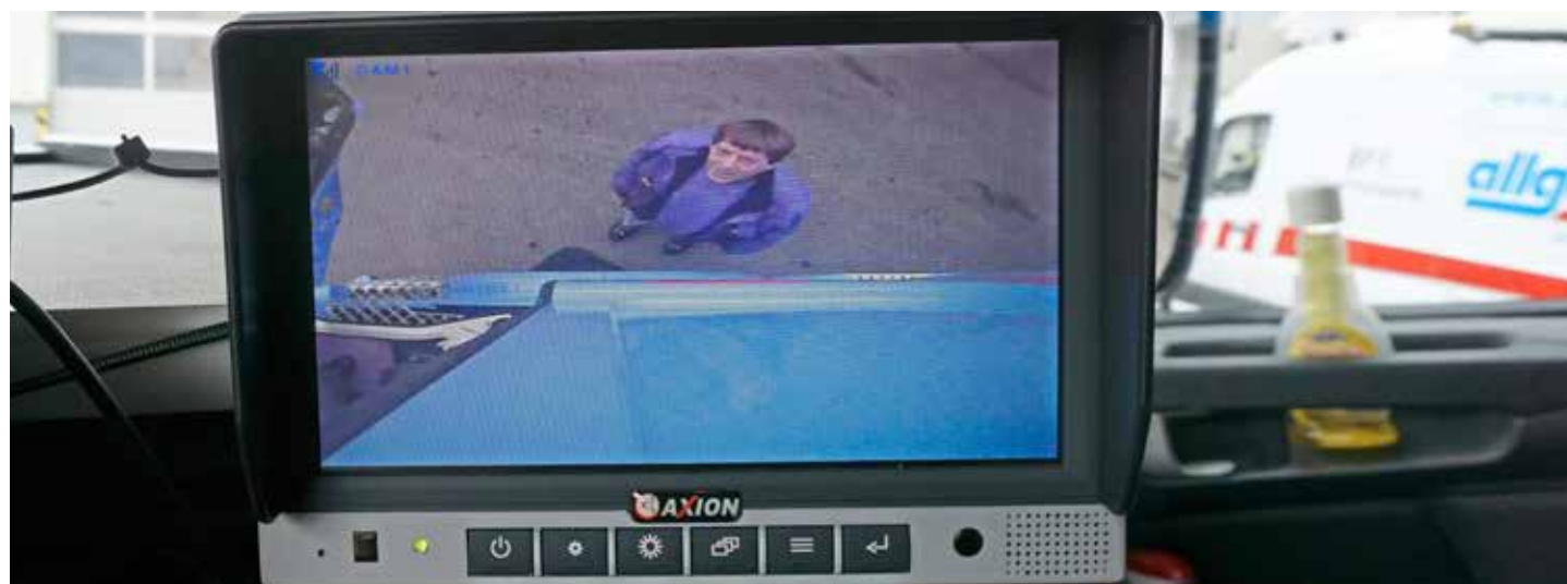
Ein Kamerasystem für den toten Winkel gehört bei der Spedition Allgaier ebenso zum Risk-Management wie regelmäßige Fahrerschulungen.
